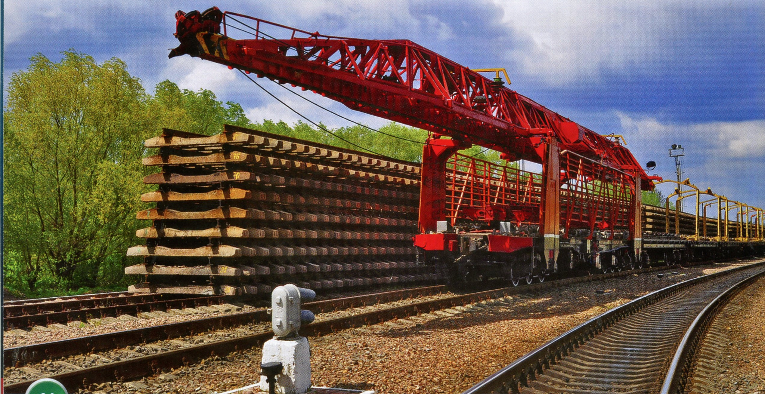
▼ Такой путеукладчик строит железную дорогу из готовых звеньев.
