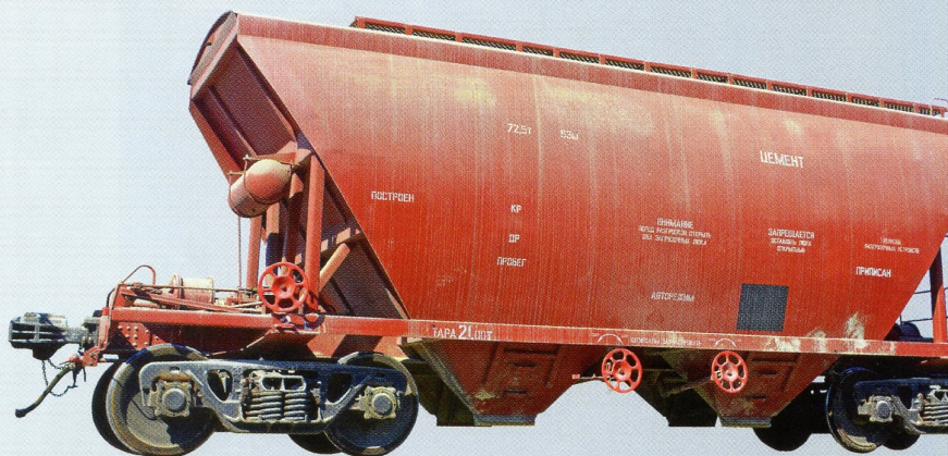
▲ Вагон-хopper предназначен для выгрузки гравия определенными порциями.
